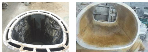
图 4 隧道二衬模型 Fig.4 Tunnel lining model
